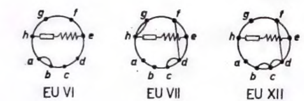
Links: Bild 11. Im Erregerstromkreis wird ein Widerstand benutzt.
