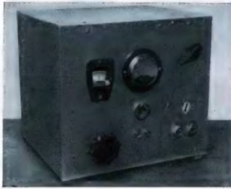
Bild 1. Vielfeitig verwendbarer Frequenzmesser in vollig abgeschirmtem Aufbau.
