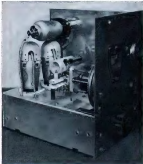
Bild 4. Der Hochfrequenzteil mit Schwingkreis.
