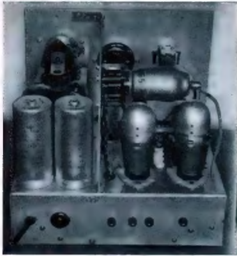
Bild 3. Aus der Rückansicht wird die klare Aufteilung des Netzteiltes (links) und des eigentlichen Frequenzmesserteiles (rechts) ersichtlich.
