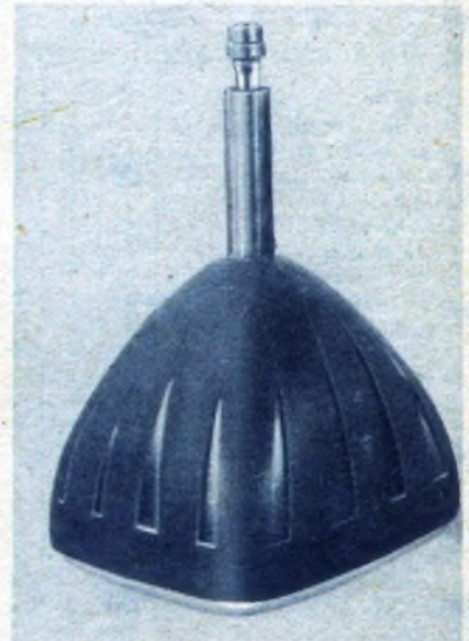
Die neue Bildröhre mit rechteckigem Kolben und flachem Bildschirm liefert ein Bild bisher nicht gekannter Schärfe und Verzerrungsfreiheit.
