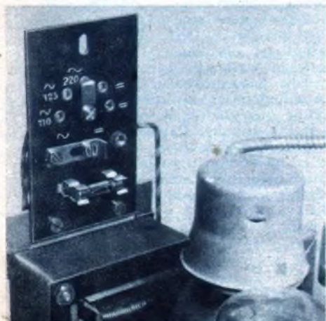
Die Umschaltleiste auf dem Spartransformator.
