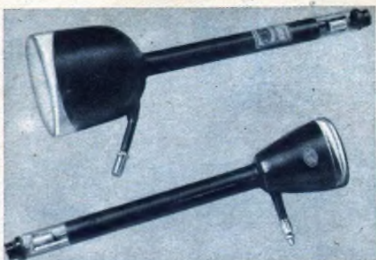
Bild 1. Projektionsröhren der C. Lorenz AG., oben für Großprojektion, unten für Heimprojektionsempfänger.
