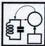
Abb. 1. Links in der Abbildung der Hilfschwingkreis, in vereinfachter Form dargestellt, rechts daneben der Kreis, der die Röhre andeutet. Die Anodenstromquelle, die die zur Schwingungserzeugung notwendige Leistung liefert, ist durch ein Viereck veranschaulicht.
