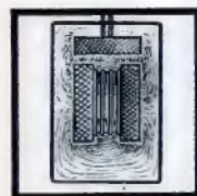
Links: Abb. 1. Spule mit eisenhaltigem Kern und Abgleichteil. Das Magnetfeld ist so dargestellt, als ob es durch Eifen-teilspäne sichtbar gemacht wäre. Die dünne Umrandung deutet den Spulen-becher an.
