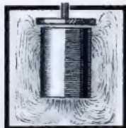
Links: Abb. 1. Spule mit eisenhaltigem Kern und Abgleichteil. Das Magnetfeld ist so dargestellt, als ob es durch Eifen-teilspäne sichtbar gemacht wäre. Die dünne Umrandung deutet den Spulen-becher an.
