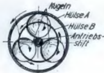
Links: Abb. 1. Skizze zur Veranschaulichung der Wirkungsweise des Knopfes.
