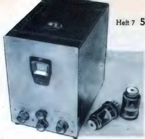
Der HF-Prüfgenerator mit zwei der auswechselbaren Spulen.
