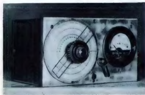
Die fertige Skala auf einem Wellenmesser. Sie besitzt hier Gradenteilung, doch kann nach Belieben auch eine Frequenzteilung vorgenommen oder Stationsnamen aufgesetzt werden. (Aufn. v. Verfasser)
