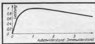
Abb. 2. So ändert sich die Leistung bei gleicher Aussteuerung mit der Anpassung. Die abgegebene Leistung ist für Gleichheit zwischen Innen- und Außenwiderstand am größten.
