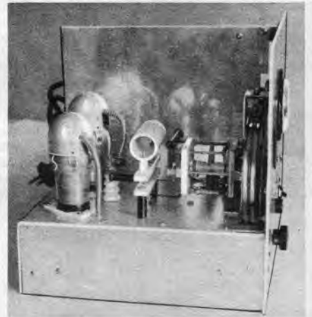
Abb. 3. Schwingkreis u. Gitterkombination sind hier besonders deutlich zu sehen.
