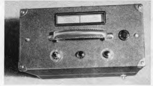
Beim Braun-Koffer-Superhet sind die Bedienungsknöpfe und die Skala von außen zugänglich.
