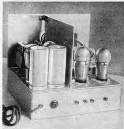
Abb. 5. An der Rückseite befinden sich Einbauficherung, Erdbuchse, zweiter Kopfhöreranschluß u. Antennenbuchse.
