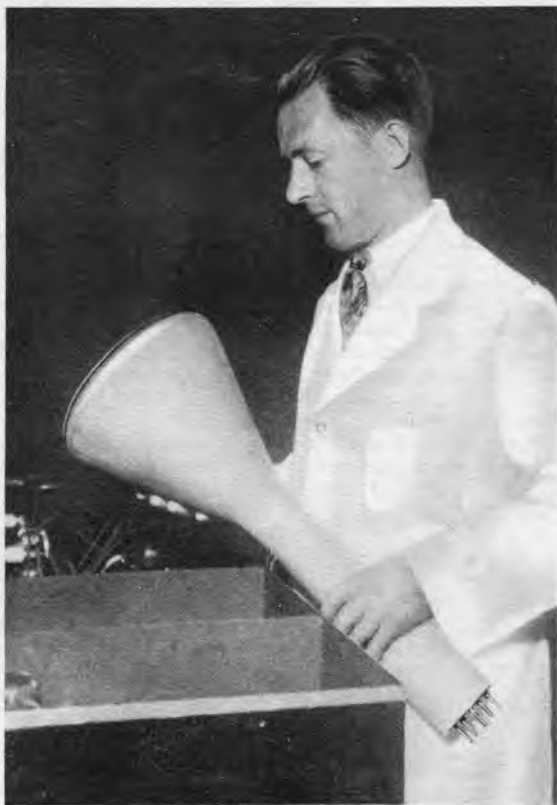
Eine fertiggestellte, metallisierte Fernrohröhre. Werk-Photo Müller.
