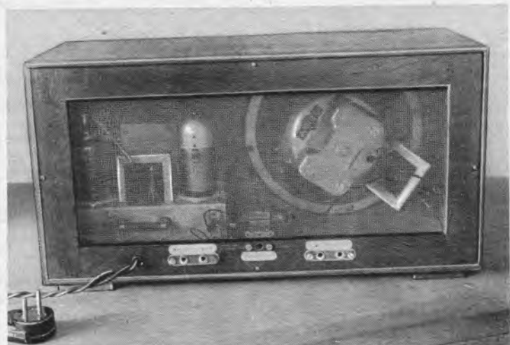
Berührungssicher! Dieser oberste Grundfatz beim Allstrom-Empfänger ist nach Aufsetzen der Gehäuserückwand erfüllt. In der Mitte ist die Sperrkreiseinstellung zugänglich (der Sperrkreis ist unmittelbar an der Rückwand befestigt). Links davon sitzt eine zweipolige Trolitul-Buchsenleiste für Antenne und Erde, rechts eine für den zweiten Lautsprecher. Wer es für nötig hält, wird noch einen kleinen Schalter zur Abschaltung des eingebauten Lautsprechers anbringen. (Aufn. Nieftle: 2)
