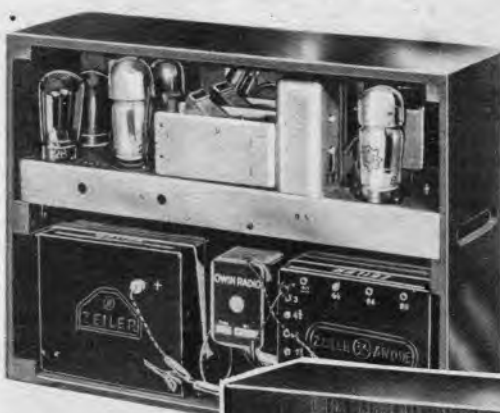
Links: Im Gehäuse oben das Gerät selbst, unten Lautsprecher, Heiz- und Anodenbatterie. Ein Blick in einen Kofferempfänger von rückwärts.
