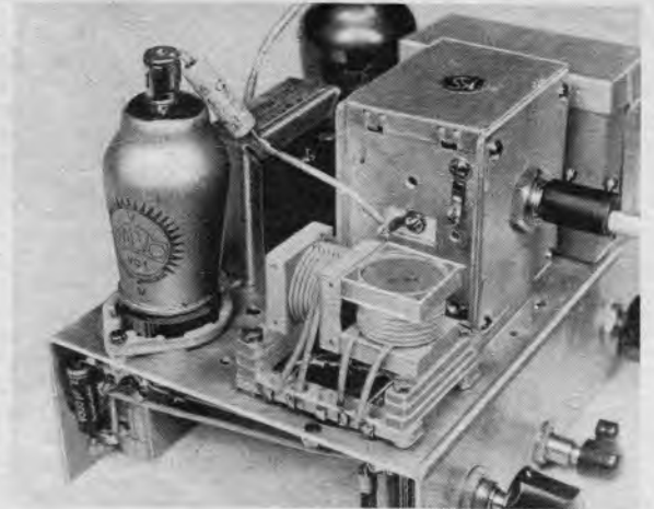
Die Spulen sind besonders deutlich zu sehen. Die Gitterkombination ist unmittelbar am Gitterclip der Audionröhre angebracht. Die Kondensatorachse rechts ist durch eine Isolierkupplung stromlos gemacht.
