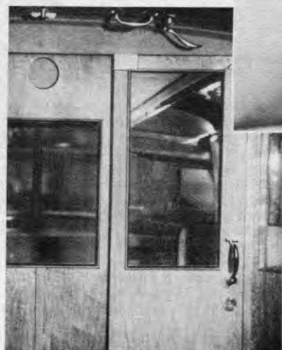
Bild links: Der zweite Lautsprecher ist unmittelbar neben der Tür in den Fahrgastraum untergebracht.
