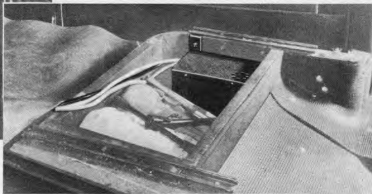
Bild unten: Das Stromverforgungsgerät, das aus der Wagenbatterie gespeist wird und die Spannungen für den Empfänger erzeugt. Es kann leicht im Werkzeugkasten untergebracht werden.
