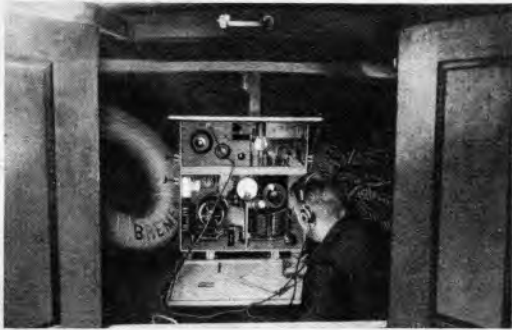
Das Funkgerät im Rettungsboot auf großem Fahrgastdampfer, wasserdicht gekapselt und mit eigener Stromquelle versehen; es sichert auch in Notfällen noch eine Verbindung mit den zur Rettung herbeikommenden Schiffen. Photo Hermann Ziefener, Hamburg.
