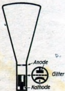
Abb. 6. Ein Vergleich zwischen Rundfunkröhre und Fernröhre.
