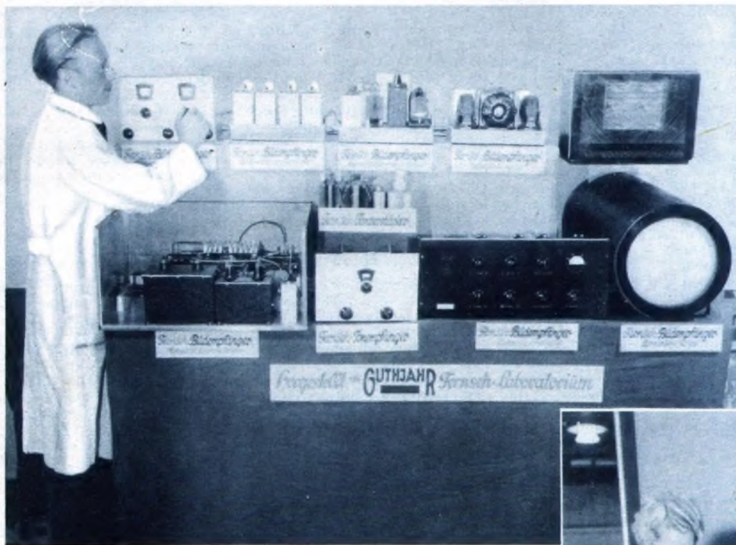
Hier sehen unsere Leser einmal eine vollständige Empfangsapparatur für Fernsehen, eine ziemlich umfangreiche Anlage. Links: Eingangsstufe und Mischer, dann der Zwischenfrequenzverstärker, anschließend der Endverstärker und Gleichrichter. Die vierte Einheit bildet das Netzanschlußgerät, rechts davon der Lautsprecher. Die untere Reihe wird ausgefüllt vom Netzgerät für die Fernlehröhre, daneben Tonempfänger und Tonverstärker, anschließend das Kippgerät und schließlich die Braunische Röhre selbst. Werkphoto.
