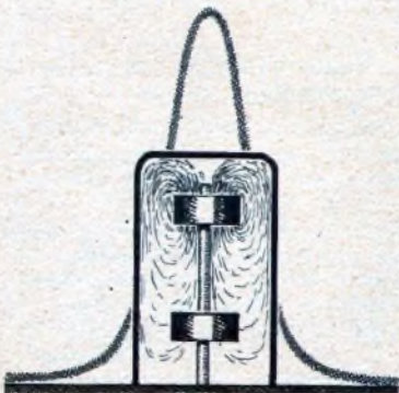
Zwei Spulen koppeln aufeinander; aber sie sind weit von einander entfernt, koppeln also nur lose. Die daraus resultierende Resonanzkurve ist typisch für Empfänger höchster Trennschärfe, aber mit unterdrückten hohen Tönen.
