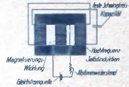
Abb. 15. Veränderung der Abstimmung durch Vormagnetisierung des Eifenkerns.
