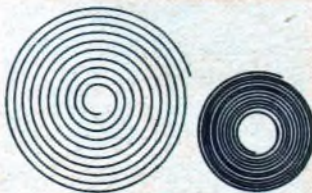
Abb. 11. Eine Spule aus federndem Metallband aus- und eingerollt.
