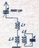
Abb. 3. Die zu treffende Schaltung zur Antennenabstimmung.
