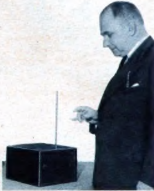
Abb. 6. Die Veränderung der Abstimmung geschieht bei dem sog. Theremin-Gerät durch Annäherung der Hand an einen Metallstab.
