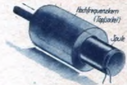
Abb. 14. Die Spule wird in einen Eifenkern mehr oder weniger eingeföhoben.
