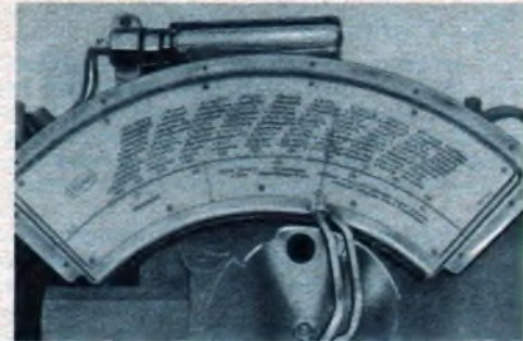
Oben: Abb. 1. Der hier gezeigte Skalenantrieb bewirkt, daß auf der linken Seite der Skala der Zeiger schneller wandert als auf der rechten. Werkphoto: Saba
