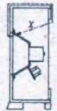
Abb. 3. Um gute Wiedergabe der tiefen Töne zu erzielen, muß die mit X bezeichnete Weglänge mindestens 60 cm betragen.
