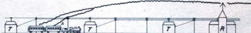
Beim Zugfunk, der nicht leitungsgerichtet ist, breiten sich die drahtlosen Wellen frei aus und erreichen so unter Umgehung der Telephonstationen (T) die Empfangsstation in R oder umgekehrt von dieser Sendestelle aus den Zug.
