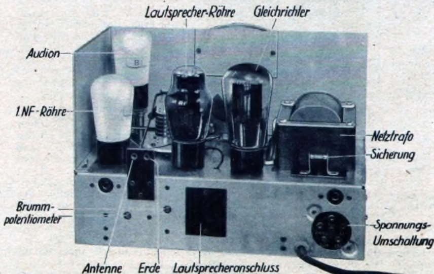
So sieht der UKW-Spezialempfänger aus, wenn man die Rückwand abnimmt.
