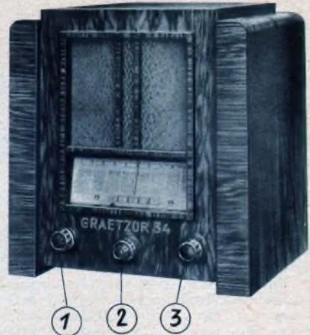
Das schicke Gerät von vorne gesehen. 1. Der Generalschalter, der die Aus- und Einschaltung des Gerätes bewirkt, bzw. Tonabnehmer und die Wellenbereiche einschaltet. 2. Klangfarben- und Lautstärkeregler. 3. Abstimmung.
