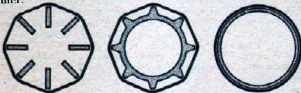
Rohr-, Stern- und Steg-Spulenkörper im Schnitt.
