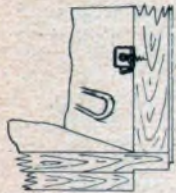
Links eine Skizze, die zeigen soll, welcher Befestigungswinkel abzuschrauben ist, um das Chassis herausziehen zu können.
