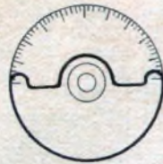
Der obere Teil der ursprünglichen Skala muß gemäß dieser Skizze weggeschnitten werden, wenn man die feststehende Volllichtskala von hinten durchleuchten will.
