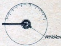
So muß der Zeiger an die Achse angeleitet werden, wenn man eine feststehende, voll zu übersehende Skala anbringen will.
