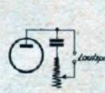
Abb. 9. Ein sogenannter negativ logarithmischer Regler, als Klangfarber geschaltet
