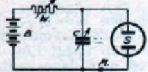
Abb. 1. Wenn man eine Glühlampe S so schaltet wie angegeben, so kann man mittels eines Kopfhörers, der an der Stelle K eingeschaltet ist, aus der Tonhöhe der entstehenden Schwingungen auf die Größe des Widerstandes W bzw. die Kapazität des Kondensators C schließen.
