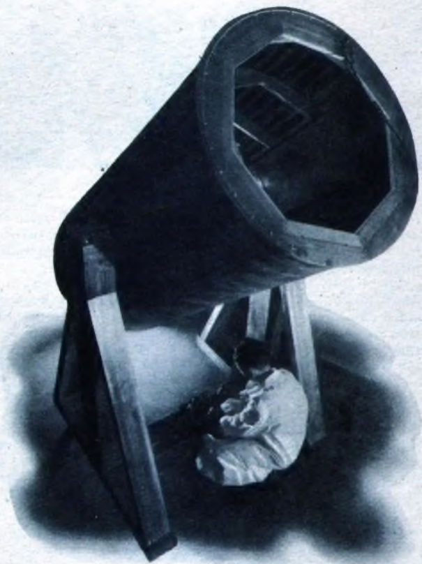
Ein Stück Welt ohne Erdmagnetismus — nämlich im Innern dieser großen Spule mit über 2 m Länge und 1 m Durchmesser. Die Kompaßnadel schwingt im Innern dieser Spule vollständig frei. Man braucht einen solchen magnetisch völlig unbeeinflussten Raum für manche magnetische Untersuchung.
