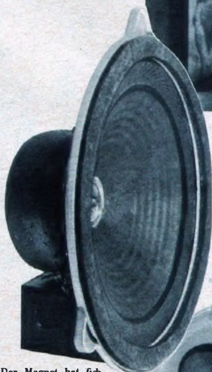
„Der Magnet hat sich kugelig zusammengezogen“. Die Membran erhielt Verstärkungsrippen. Ergebnis: Größere Lautstärke u. Klangreinheit.
