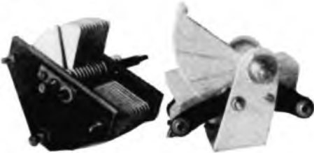
Die Entwicklung von 5 Jahren. Viel Isoliermaterial und große Anfangskapazität bei dem alten Drehko links. Daneben ein ganz modernes Stück.
