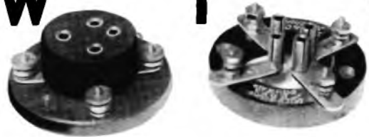
Eine alte Röhrenfassung und eine auch nicht eben junge, aber sehr verlustarme Röhrenfassung
