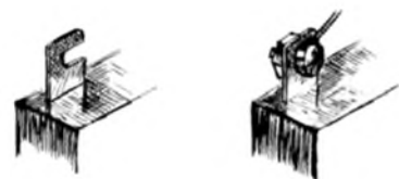
Abb. 5. So lassen sich auch gewöhnliche Kondensatoren durch Schrauben anschließen.
