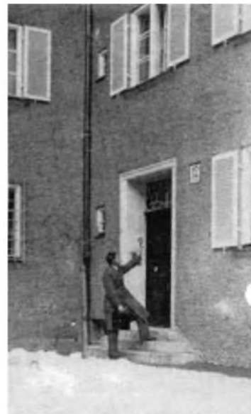
Die Tastantenne (eine Ledionspule) ans Verteilerbrett der Klingelleitung gehalten, bestätigt den Verdacht, daß wir das richtige Haus gefunden haben.
