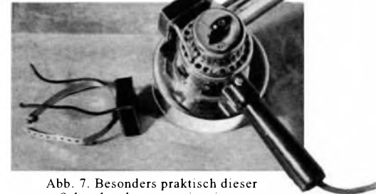
Abb. 7. Besonders praktisch dieser Schutzkondensator mit seinem Befestigungsband.
