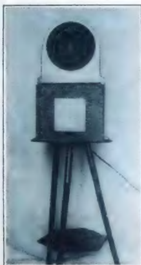
Auf der Mattscheibe unter dem Lautsprecher erscheint das Fernsehbild.
