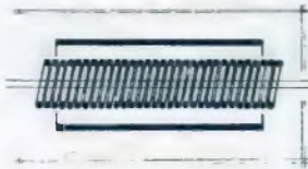
Abb. 5. Wie der Schnitt durch ein System einer normalen Röhre mit 1% Durchgriff ungefähr aussehen würde.
