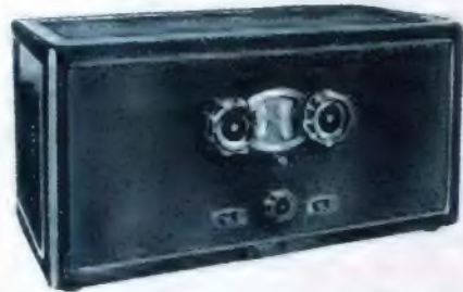
Bei dem in diesem Aufsatz genannten Loewe FE 63, einem bekannten Rahmenempfänger, ist die Selektion bei normaler Einstellung nicht größer, als daß eine Anzahl entfernter Stationen wirklich verzerrungsfrei aufgenommen werden kann.
