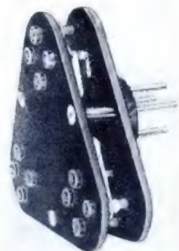
Der Lange-Mehrfachstecker gestattet in normalen Empfängern bis zu drei Endröhren parallel geschaltet zu betreiben.
