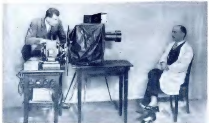
Die Abtastung des Bildes auf der Sender- und das Zusammensetzen auf der Empfänger-
