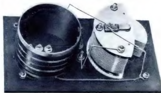
Ein Schwingungskreis in der Praxis. Links Spule, rechts Drehkondensator (Fribro-Detektorapparat).
