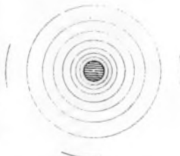
Abb. 8. Der einzelne Draht mit seinem Magnetfeld. (vergl. Abb. 7)
