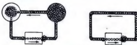
Abb. 6. Anordnung zur Erzielung eines Dauerstromes
