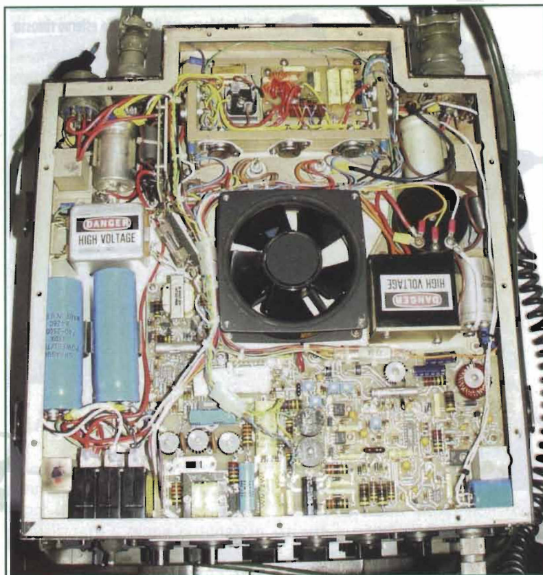
Foto 5 : Vista interna dal basso dell'alimentatore RF-2360
