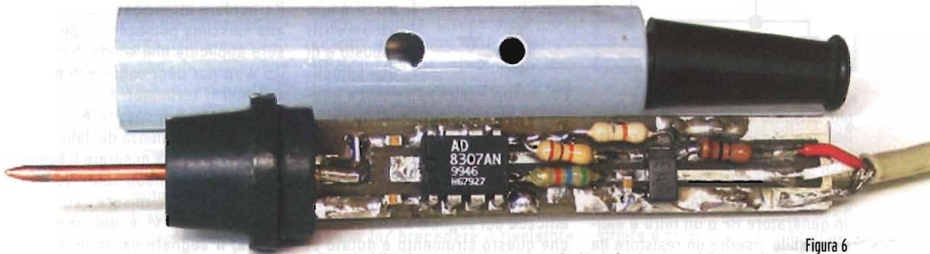
Figura 6 La parte dello schema elettrico racchiusa nel tratteggio è qui stata montata su un piccolo stampato per poter essere inserita in una custodia di una vecchia sonda per oscilloscopio provvista di puntale.
