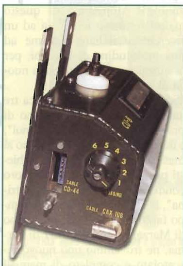
foto 5 Iret CU-8: frontale con nonio e presa d'antenna
