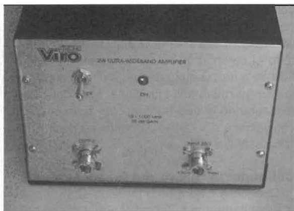
figura 8 - L'amplificatore incasellato pronto per il laboratorio della Viro Tronic. Le scritte sono stampate su una etichetta metallizzata della "Océ" per stampante laser, un sistema decisamente eccellente e decisamente consigliabile.
