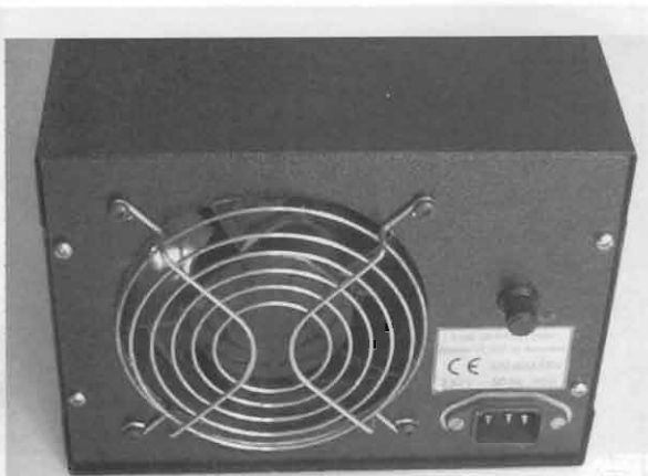
figura 6 - Pannello sul retro della scatola. La grossa ventola è protetta dalla retina anti-intrusione, mentre tra il fusibile e la spina di rete c'è l'etichetta con i dati dell'alimentazione richiesta.
