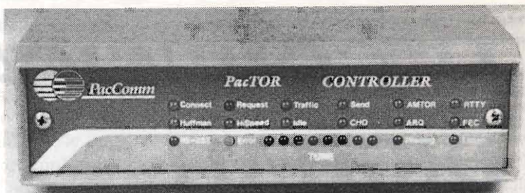
figura 2 - Come potete osservare da questa foto, questo TNC della PacComm, supporta oltre al PacTOR anche i modi: RTTY, AMTOR e CW.
