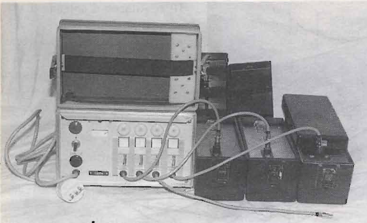
Foto 10 - Carica batterie in funzione su tre pacchi. Nel coperchio i fusibili e le lampadine di ricambio.
