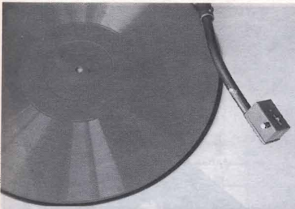
figura 2 - Il disco magnetico e la testina.
