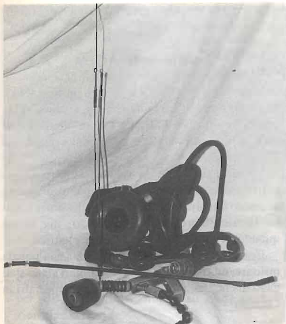
Foto 5 - R126. Cuffia monoaurale con laringofono; antenna Kulicow; notare lo stub regolabile.
