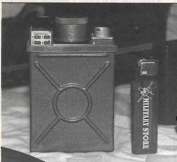
Foto 9 - R147. Vista di fronte con tabella frequenze.
