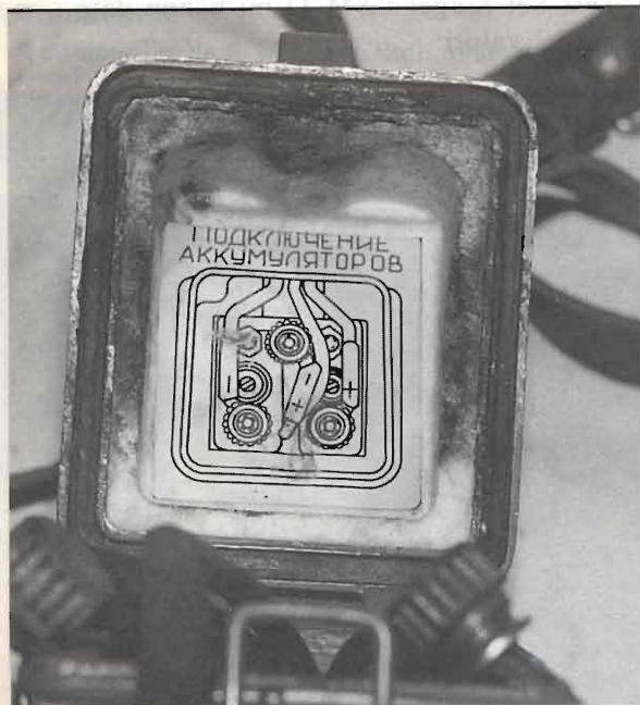
Foto 6 - R126. Coperchio vano batterie e schema di montaggio delle stesse.
