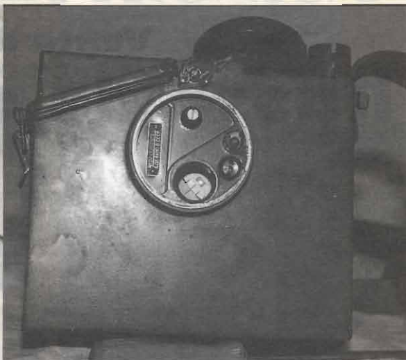
Foto 3 - R126. Particolari della scala: la manopola di sintonia, la lampadina e l'interruttore della stessa.
