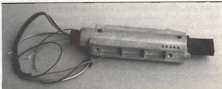
Foto 1 - Uno scintillatore completo di fotomoltiplicatore e circuito di alimentazione proveniente da uno strumento medico-diagnostico tipo TAC. Il cristallo scintillatore è costituito da ioduro di sodio ed è incapsulato ermeticamente nell'appendice di gomma nera visibile all'estremità del contenitore cilindrico.
