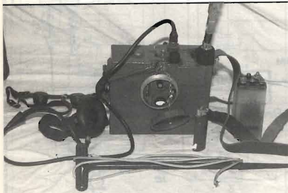
Foto 1 - R126 completa. Notare il coperchio della sintonia e il picchetto della terra a mò di contrappeso.
