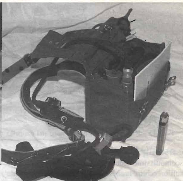
Foto 13 - R147: versione pesante con particolare sull'antenna nella cinghia.
