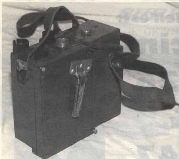
Foto 2 - R126 lato destro. Notare la grossa clips di fissaggio al cinturone e la vite per il contrappeso di terra.
