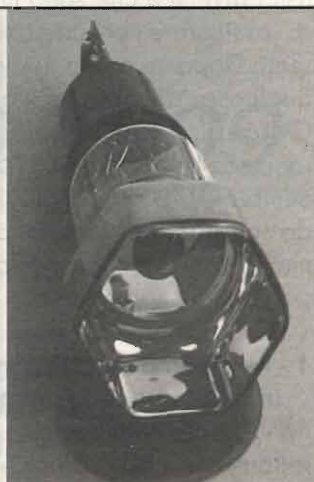
Foto 3 - Vista frontale della finestra sensibile del fotomoltiplicatore della Foto 2. La forma esagonale permette di montare più sensori disposti "a nido d'ape" su una grande "pizza" di cristallo scintillatore, in modo da ricostruire una immagine della sorgente radioattiva (scintigrafia).
