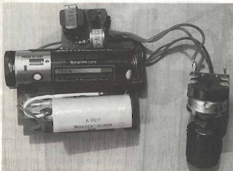
figura 9 - Foto della scheda modificata per lo strobflash.
