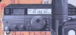
IC 736 - Rx: 500 kHz-30 fino a 100W di potenza RF - Selettore automatico
