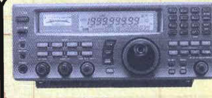
IC R8500 - Rx da 100 kHz a 2 GHz nei modi CW, SSB, AM, FM, AM/W, AM/N, FM/W, FM/N - funzione IF SHIFT e APF
