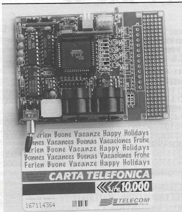
Foto 2 - La scheda LPDL a confronto con le ridotte dimensioni di una scheda telefonica.
