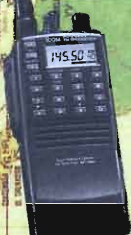
IC 2 GX ET - Portatile bibanda VHF/UHF in FM caratterizzato da semplicità operativa, alta potenza RF (7W) ed impermeabilità a polvere e schizzi d'acqua.
