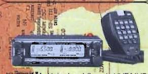
IC 2700 H - Veicolare bibanda VHF/UHF Tx: 144/146 - 430/440 MHz Rx: 118/174 - 320/470 MHz Con modifica ricezione da 830 a 999 MHz
