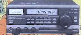
FRG 160 - Ricevitore multimodo HF da 50 KHz a 50 MHz - Alla selettività e doppia conversione in SSB, CW, AM, FM, DPM memoria
