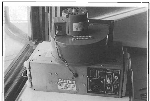
Foto 1 - Laser Head: sulla sommità la grande ventola, a destra il pannello di controllo col pulsante Test, potenziometro e LED, infine il connettore di alimentazione.
