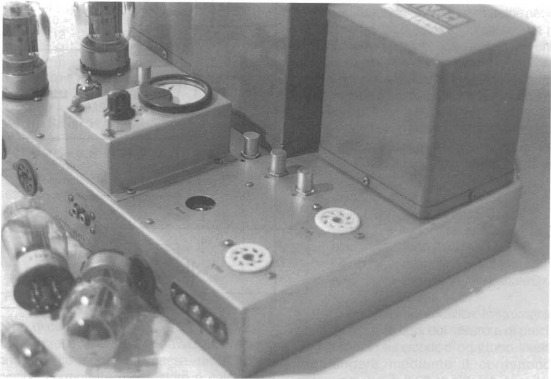
Foto 2 - Vista parziale con il sub-telaio per polarizzazione e bilanciamento.
