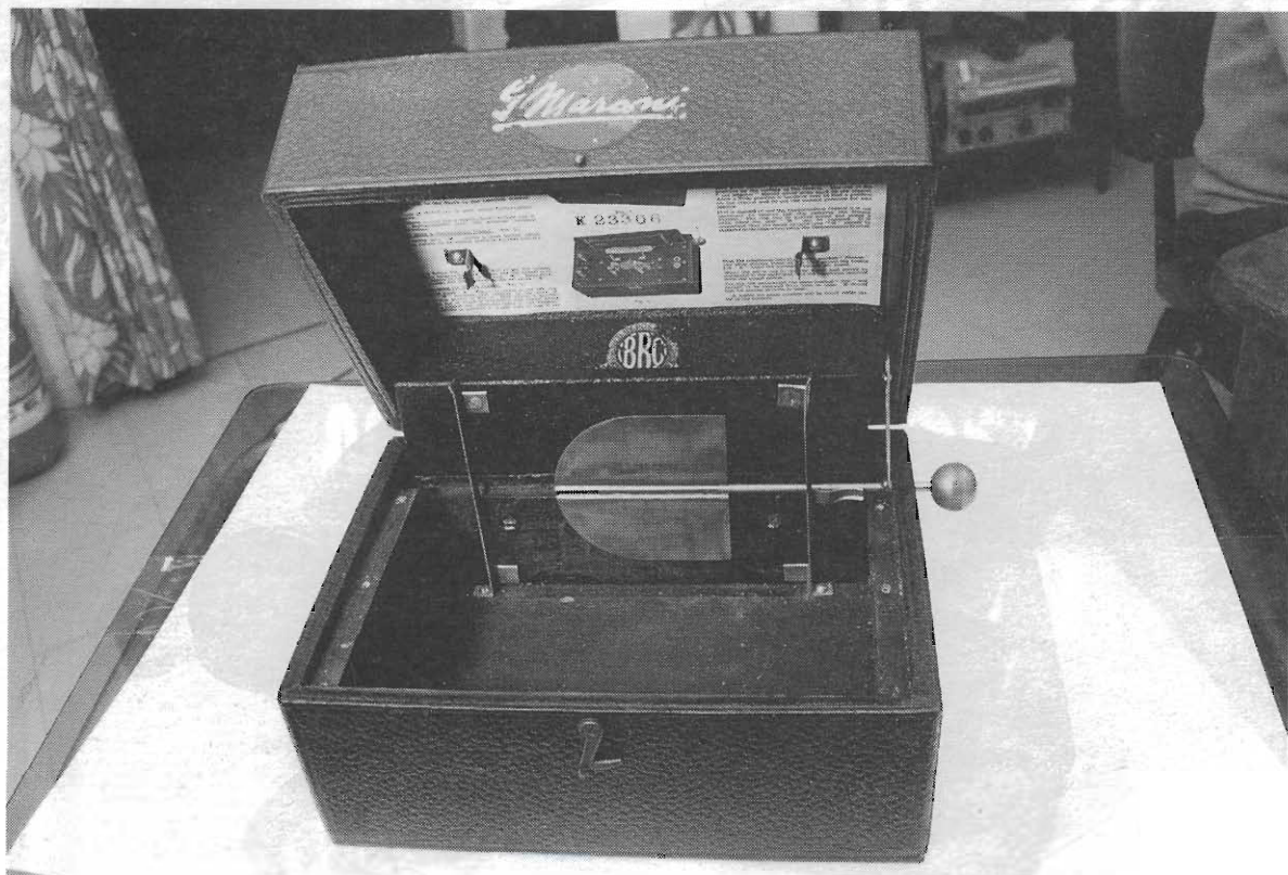
figura 3 - Il pannello di ebanite è stato asportato per mostrare l'interno del contenitore con la lamina di rame del variabile e le guide verticali della bobina.
