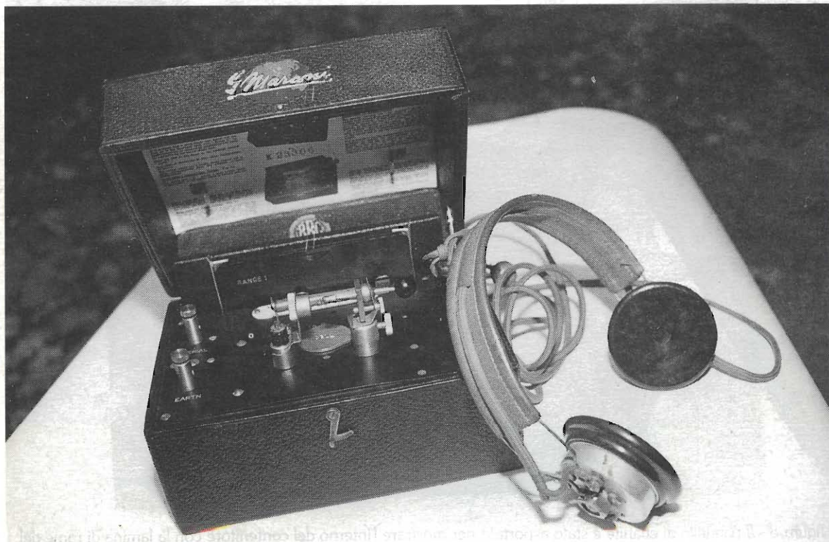
figura 1 - Ricevitore Crystal Junior con la sua cuffia d'ascolto.
