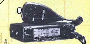
TM732 - Nuovo bibanda 50W VHF e 35W UHF, programmabile, 50 memorie, pannello frontale staccabile
