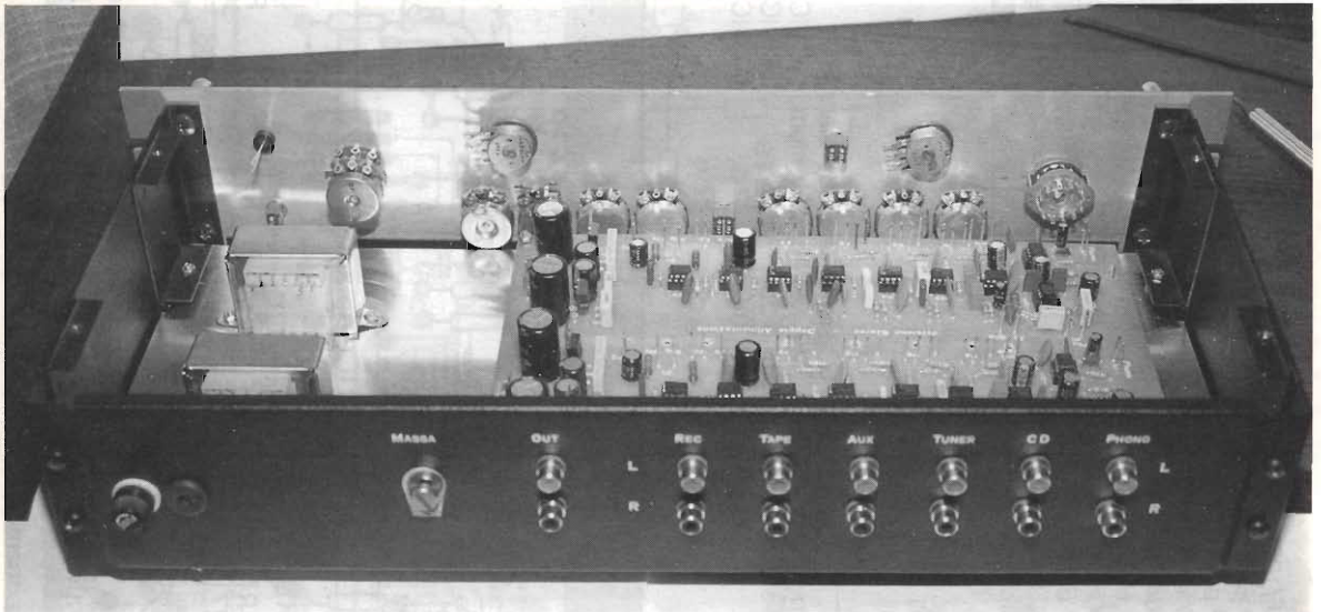
Foto 4 - Vista retro/interno del preamppli con cablaggi ancora da effettuare. Notare in buona evidenza i pin-up dorati.
